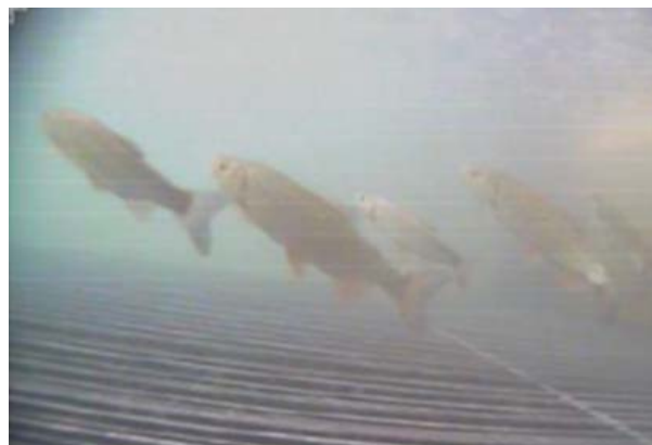
Abbildung 4: Unterwasserfoto vom Fischverhalten über dem Horizontalrechen (VA Obernach)
